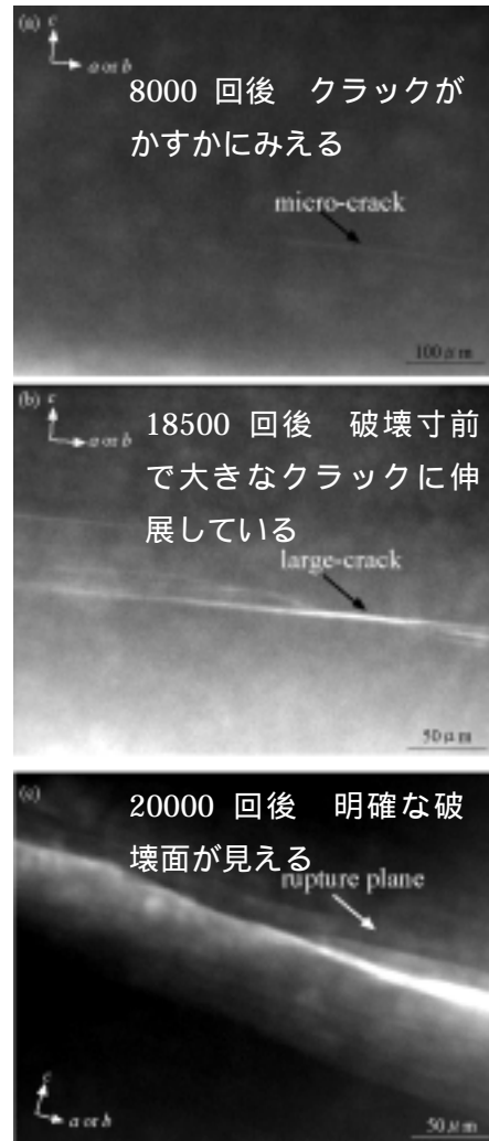
図6 超電導バルク体の繰返し 負荷とX線によるクラック進行観察
