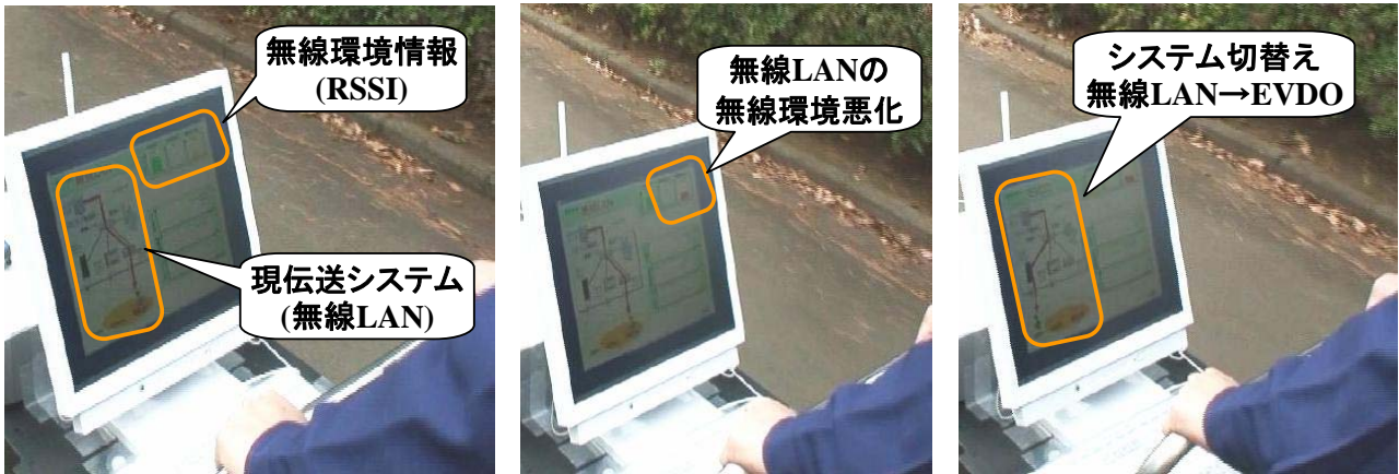
図9 システム切替の様子（左：無線LANでの通信，中央：受信レベル劣化，右：EVDOでの通信）
